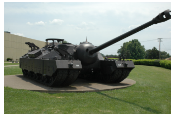
Le prototype du T-28, char super-lourd conçu par les Américains à la fin de la Seconde Guerre mondiale, un char caractérisé par son double train de chenilles, nécessaire pour supporter les 85 tonnes du joujou. Comme quoi, il n'y avait pas que les Allemands qui étaient capables de délires technologiques !
